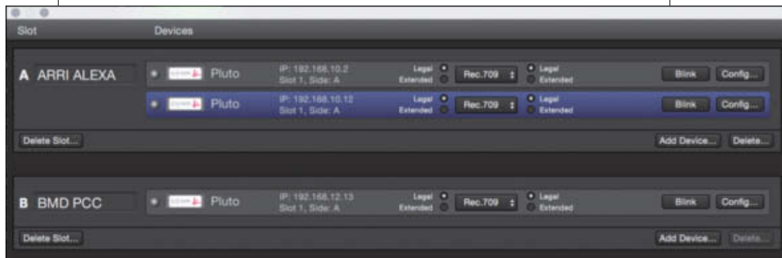
Hardware-Setup in LiveGrade, hier mit zwei Alexas und einer Blackmagic-Kamera
